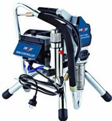
Окрасочный агрегат безвоздушного распыления краски. Работает от электрического двигателя на 220 вольт, засасывает краску из ведра, в котором она поставляется, и подает ее по шлангу в краскопульт для распыления краски безвоздушным способом.
