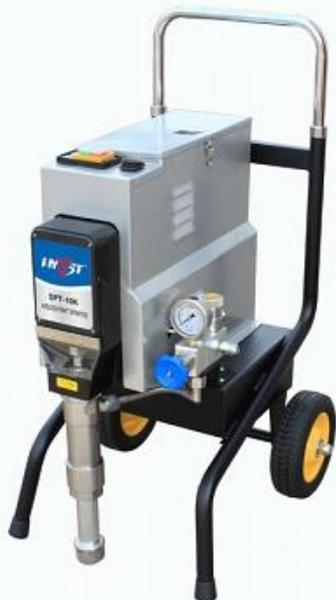
Поршневой безвоздушный окрасочный агрегат для профессионального распыления краски в условиях строительной площадки. Окрасочный агрегат предназначен для распыления вязких красок, огнезащитных составов, битумных и гидроизоляционных мастик, теплоизоляции. Может наносить краски одновременно через два краскопульта
